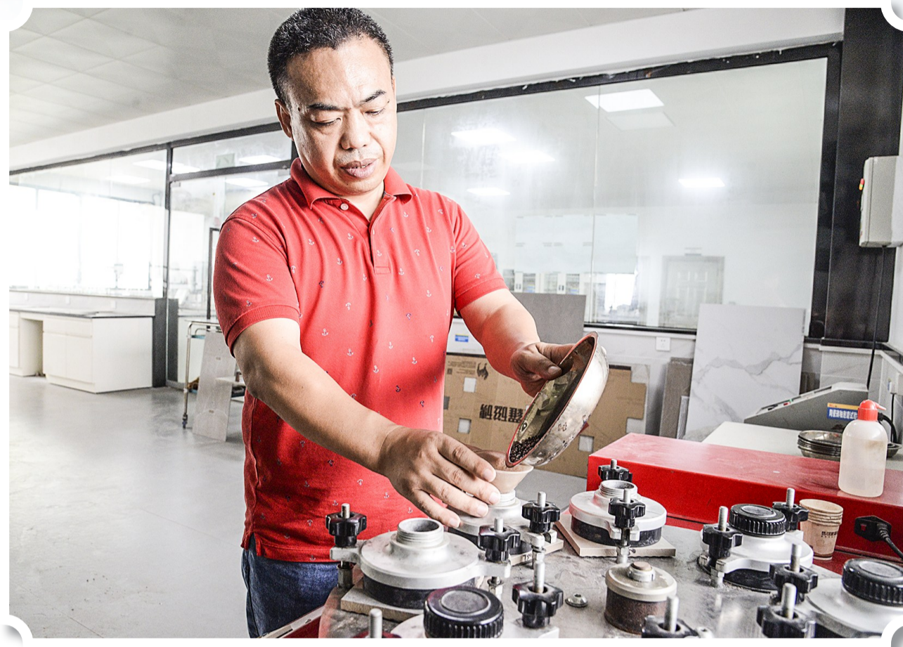
沈荣伟进行釉面砖耐磨测试
